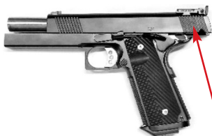
Abbildung 5.4: Durchladen mittels Verschlusses
