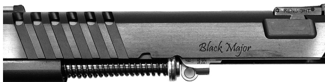
Abbildung 7.7: Verschluss mit Lauf, Kettenglied und Verschlussfedergruppe
